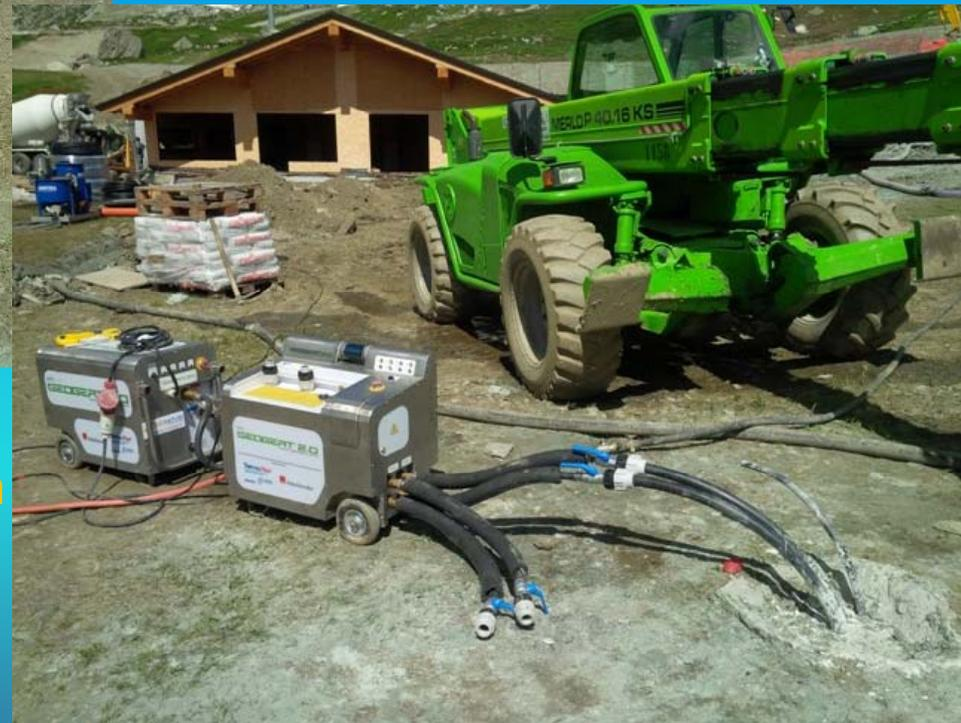
**Test sulle temperature e sulla resa termica effettiva del terreno (GRT, log termico)**
